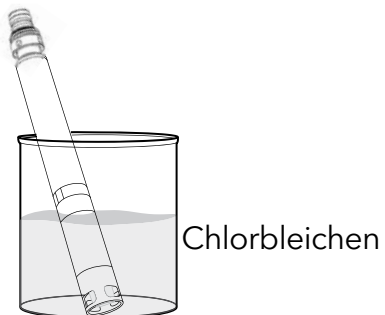
Abbildung 74 Reinigen von pH- und pH/ORP-Sensor mit Chlorbleiche
